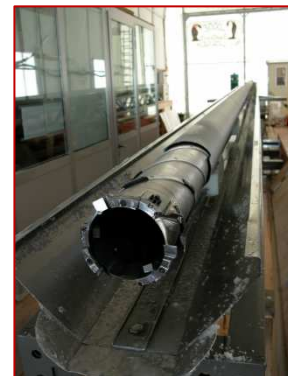
Abbildung 2: links: Frisch geborgene Eisbohrkerne. Das Eis ist manchmal sehr brüchig und kann beim Bergen durch die Druckentlastung zersplittern. mitte: Wer welchen „Anteil vom Kuchen“ erhält, ist im Voraus auf's Genaueste bestimmt: Schnittmuster für das Zersägen des Bohrkerns. rechts: Bohrkopf
