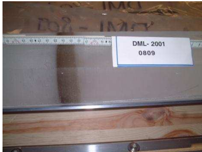
Abbildung 7: Aschenlage in einem antarktischen Eisbohrkern aus der West-Antarktis (Dronning Maud Land)
